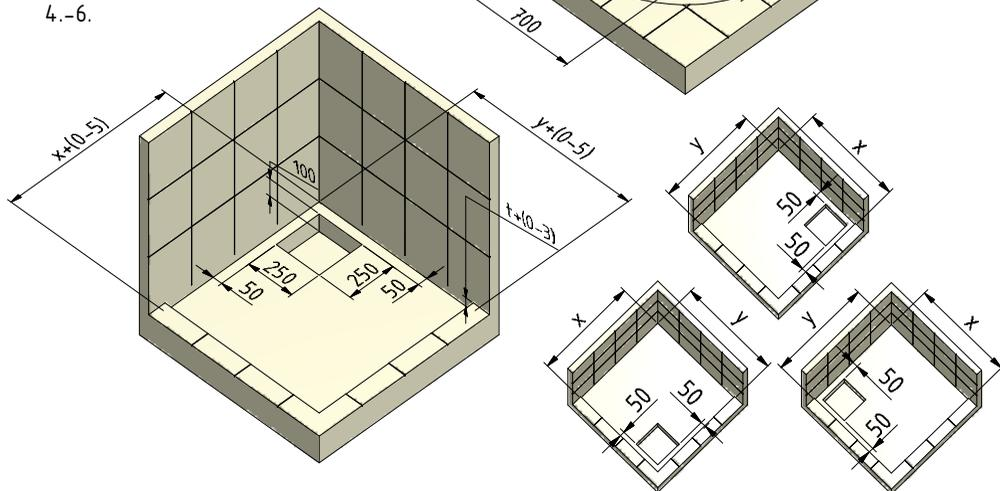
stavební připravenost \* construction preparation \* Aufbau-Vorbereitung \*
